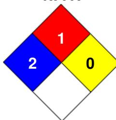
**Classification d'entreposage NFPA 30 / 30B:** Liquide combustible IIIB
